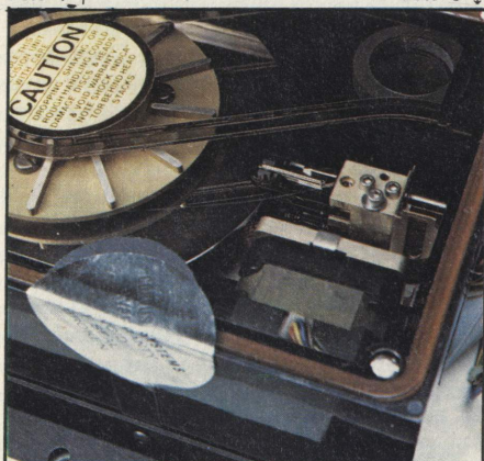
Foto 6. Particolare delle quattro testine Winchester.
